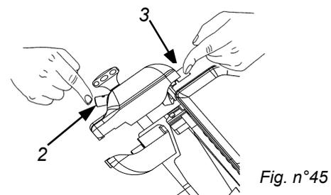
**N.B.: Non protrarre l'operazione di sbavatura oltre i 1-2 sec. per evitare la dannosa ritorzione del filo della lama.**
